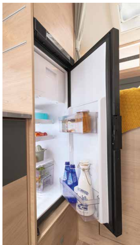
Un réfrigérateur à compression de 149 l avec compartiment congélation est installé de série.
