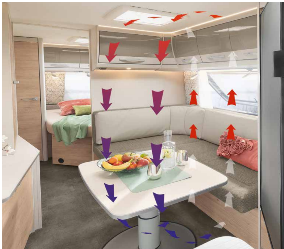
Système AirPlus pour une bonne circulation d'air derrière les placards de pavillon évitant toute condensation
