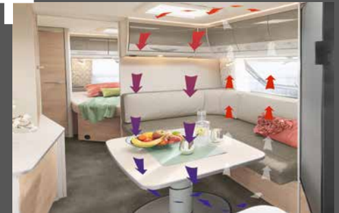
Système AirPlus pour une circulation optimale de l'air à l'intérieur et une bonne ventilation arrière des placards de pavillon et du mobilier
