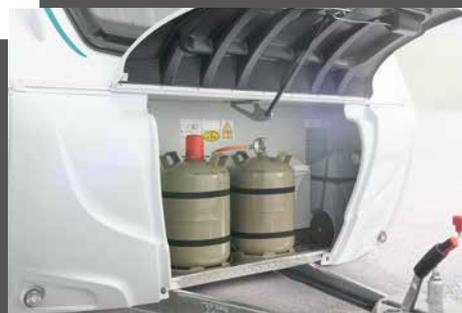
Coffre à gaz pouvant accueillir 2 bouteilles de 13 kg avec plancher solide en aluminium antidérapant et imputrescible
