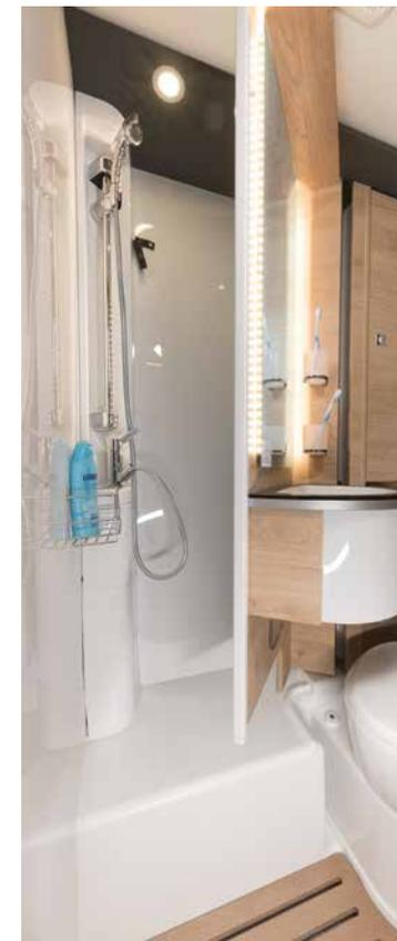
**Pour le transformer en une cabine de douche,** il suffit de débloquer le verrou et de faire pivoter la paroi au-dessus des toilettes.
